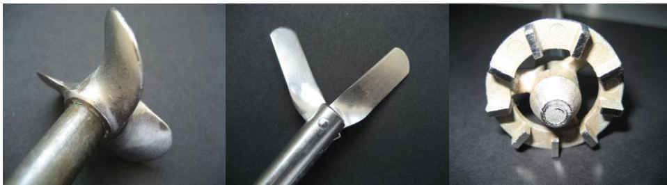
图 17: 爱卡实验室常用的搅拌头
