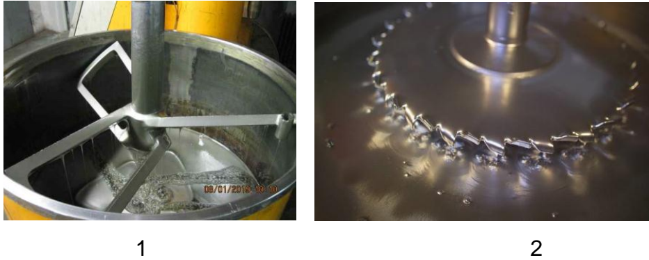
图 18: 爱卡生产常用搅拌机，低剪切蝶式混合机 (1), 和齿形转盘 (2)
