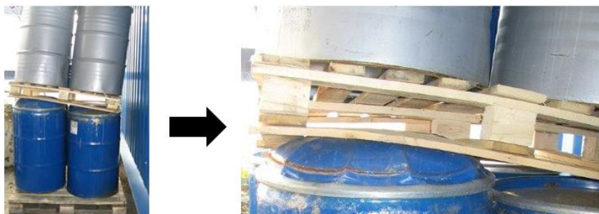
图 23: 库存油墨桶由于氢气压力发生胀桶
